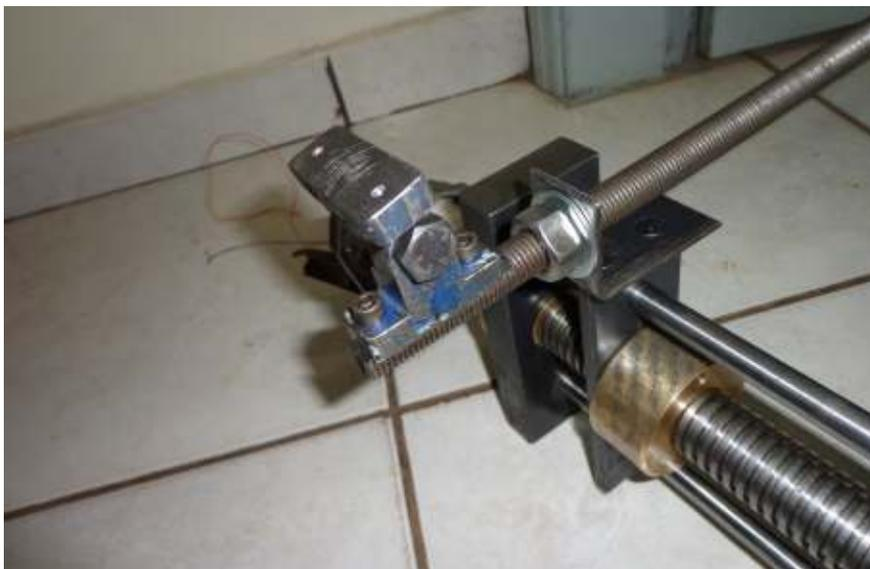
Figura 2 - dispositivo para regular o ângulo de soldagem da tocha.
