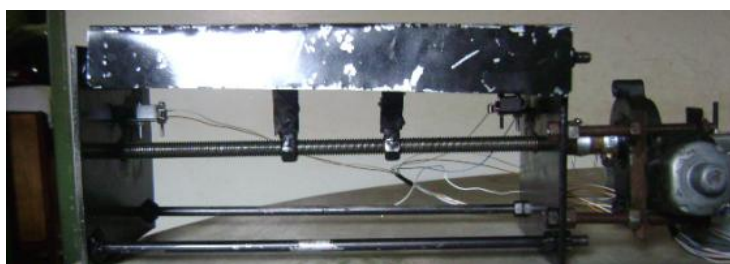
Figura 1. Vista frontal do carro de movimentação do corpo de prova.
